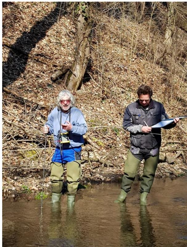
Abb. 2: Gerald Sättler und Horst Jackel, beide von der Flussmeisterstelle Salzach, arbeiten Hand in Hand. Sättler erfasst die Daten des Messflügels in einem Messgerät, Jackel protokolliert sie.
